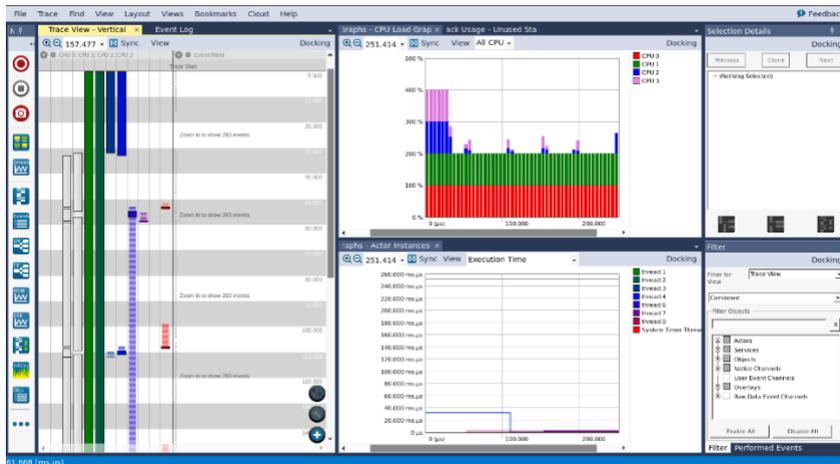
Tracealyzer montre Azure RTOS ThreadX SMP qui s'exécute sur quatre cœurs.
